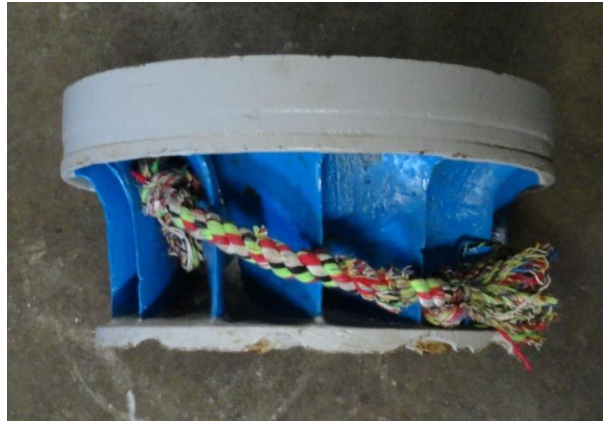
Figur 4: Ödet för en ål som försöker simma igenom kraftverkets turbiner. Trossen illustrerar hur en ål försökt simma igenom löphjulet men klämts fast av vattentrycket mot hjulets utsida.
